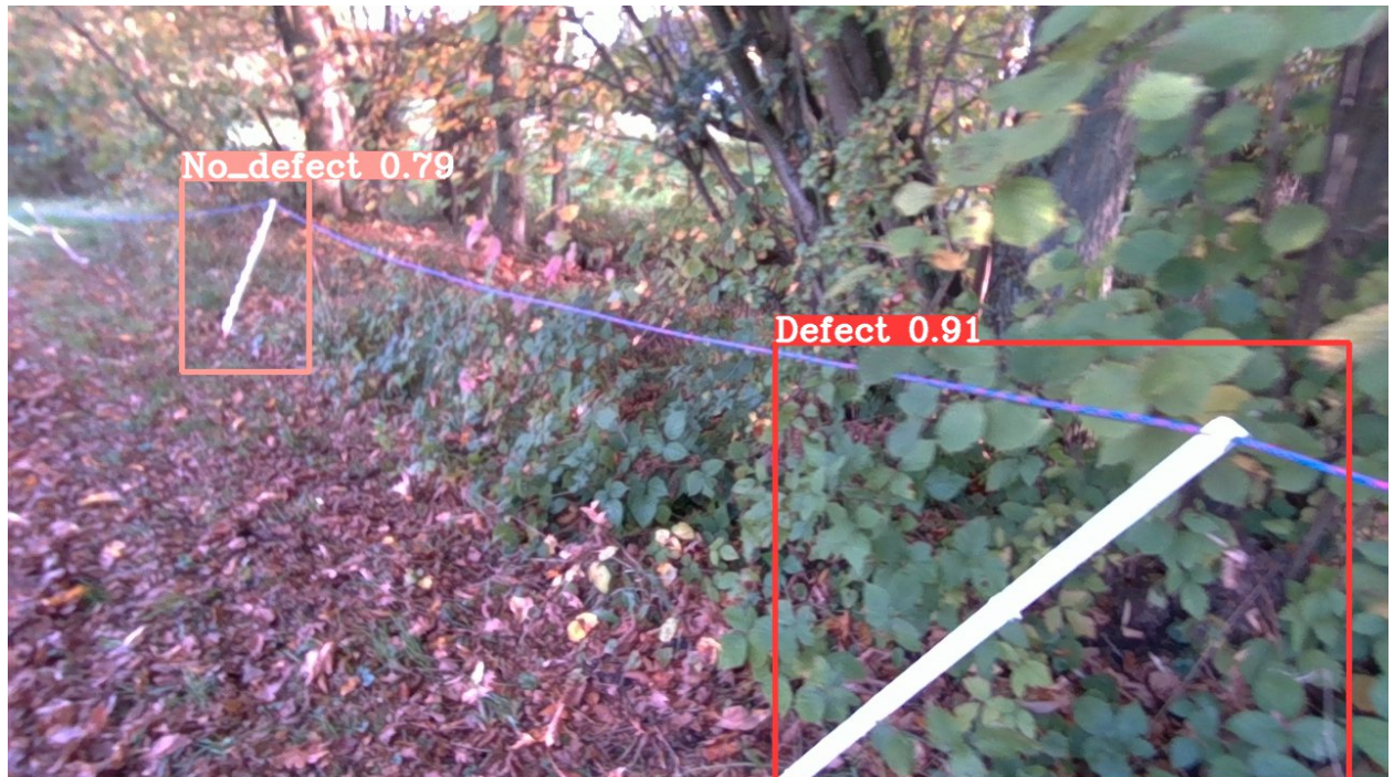
Abbildung 14: Die Erkennbarkeit von Störungen ist abhängig vom Blickwinkel. Der umgedrückte Pfosten vorne rechts wurde korrekt erkannt. Der weitgehend in Sichtachse umgedrückte Pfosten hinten links wurde nicht erkannt und ist auch für einen menschlichen Betrachter aus diesem Blickwinkel nicht eindeutig. Verwendetes Modell: YOLOv6-N6.
