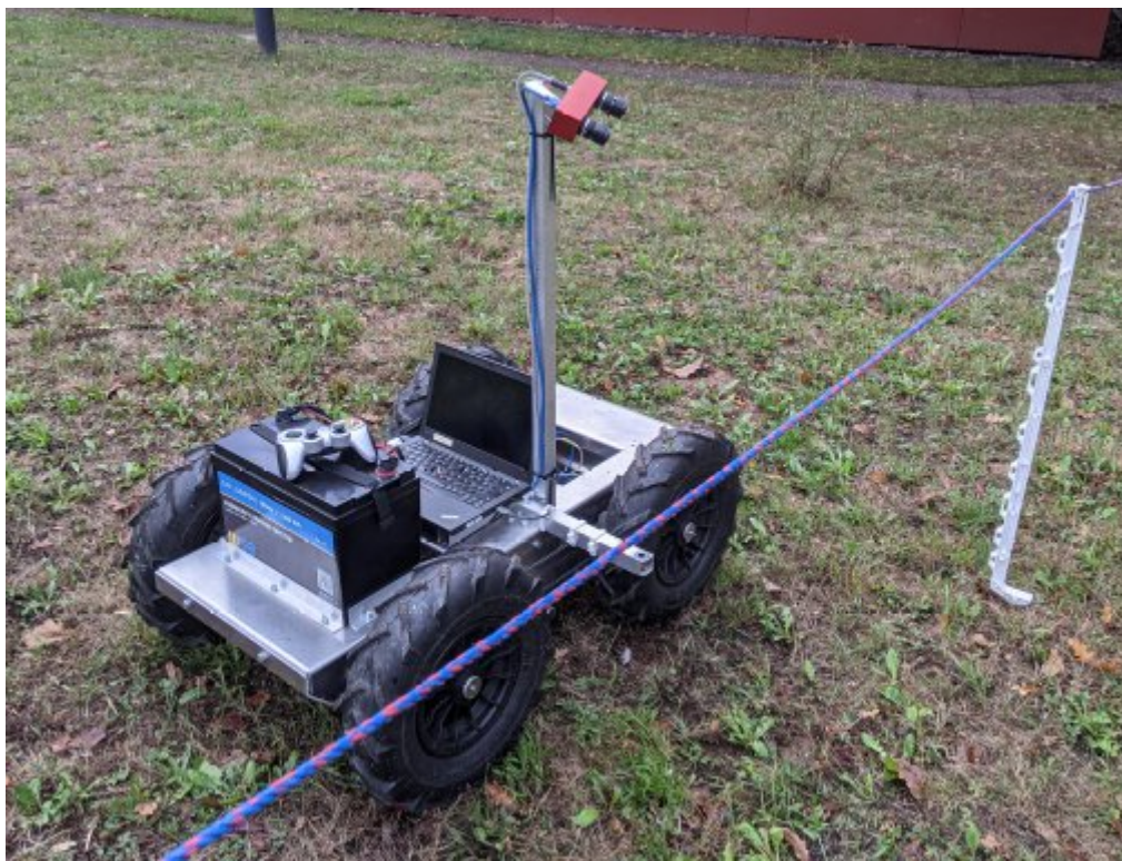
Abbildung 8: Erste Ausführung des SmartFence Rover mit vier Rädern und aufgebauter Stereokamera neben einem Zaun. Wiederholte Beschädigungen beim Wenden auf Grünland machten eine Veränderung des Antriebskonzepts notwendig. Manuelle Bedienung über Fernsteuerung (liegt auf dem Akku).
