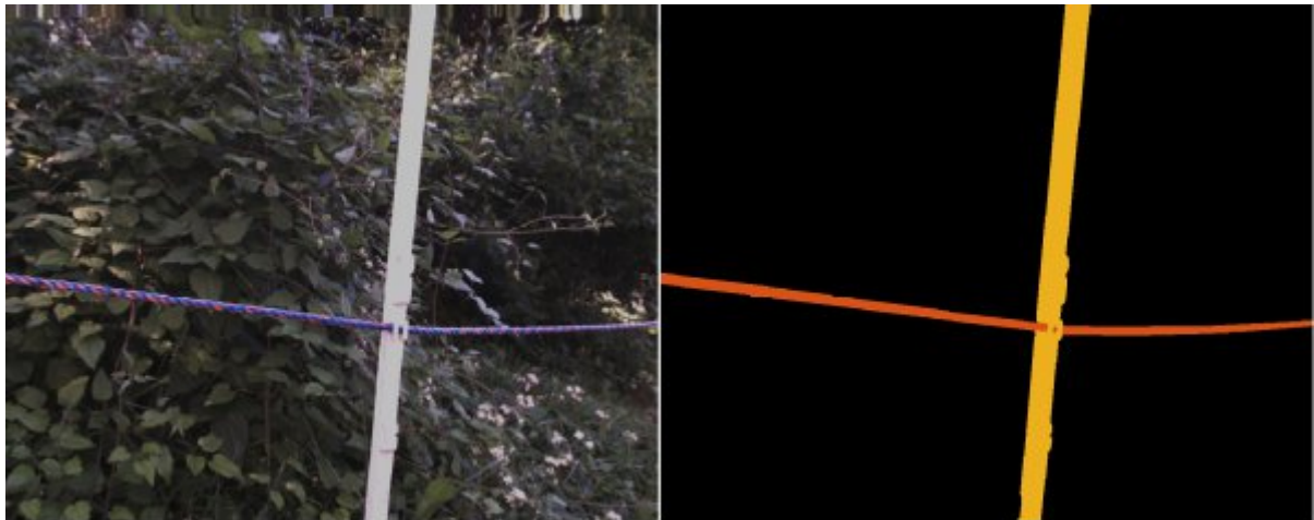
Abbildung 10: Links das RGB-Bild der Stereokamera mit Zaunpfosten, Leitermaterial und Hintergrund. Rechts die zugehörige annotation map mit den 3 Klassen: Pfosten in gelb, Leiter in rot und Hintergrund in schwarz.
