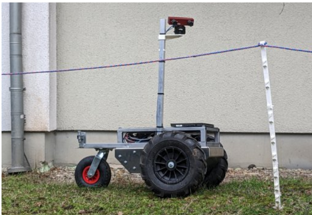
Abbildung 9: Rover mit neuem Antriebskonzept mit aufgebaueter Stereokamera. Die Plattform verfügt nun über zwei angetriebene Vorderräder und ein nachlaufendes Stützrad und ist außerdem kompakter geworden. Unter dem abnehmbaren Deckel sind Akku und Elektronik gut geschützt, das Laptop als Hauptrechner ist zur besseren Erreichbarkeit noch von außen am Deckel befestigt.
