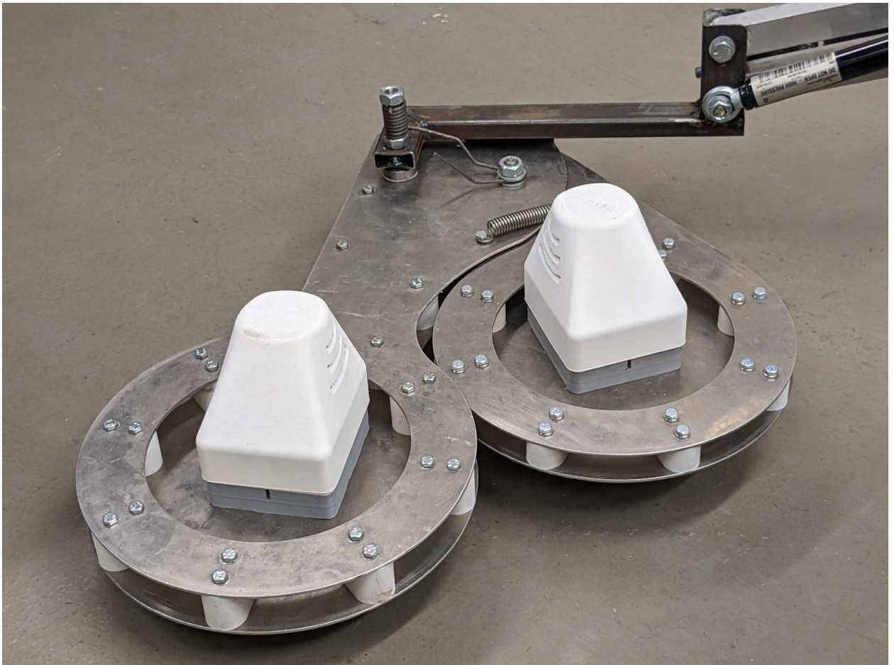
Abbildung 12: Das Doppel-Freischneider-Mähwerk wird seitlich rechts an der Rover-Plattform montiert. Oben rechts im Bild die Parallelführung mit Druckentlastung durch Gasfeder, damit das Mähwerk der Bodenkontur sanft folgen kann. Fahrtrichtung vorne ist im Bild unten.
