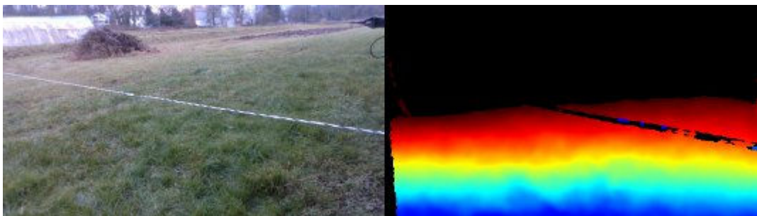
Abbildung 1: Das RGB Bild links, die zugehörige Abstandsmessung links (blau = nah, rot = fern). Die Messung des Abstands gelingt mit der Intel RealSense D435i bei Seilen und Litzen wegen ihres kleinen Querschnitts selbst im Nahbereich nur stellenweise.
