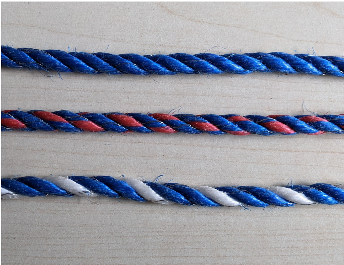
Abbildung 4: Drei Proben des Kandidatensets: a) blau (mono), blau-rot mit unregelmäßigem Muster, blau-weiß für hohen Kontrast. Durchmesser der Proben ist 8,2mm.
