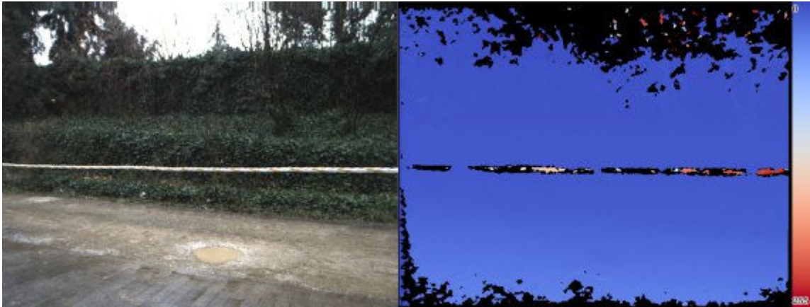
Abbildung 3: Bei horizontalem Verlauf des Leiters (hier weiß-gelbes Seil) ist das Stereo-Matching beeinträchtigt. Links eines der Farbbilder, rechts die resultierende Depth-Map. Weit entfernte Bereiche werden blau dargestellt, nahe rot. Schwarz repräsentiert fehlende Abstandsmessung.
