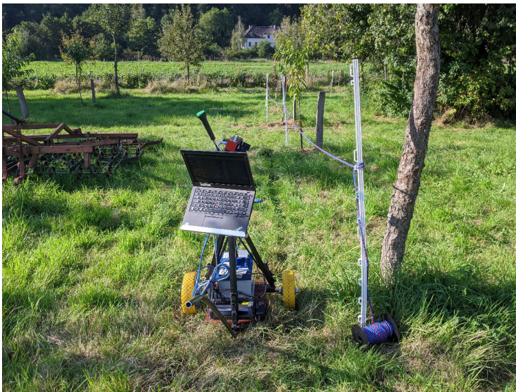
Abbildung 6: Kamerawagen mit Kamera, Stativ, Batterie und Laptop auf dem Versuchsgelände "Am Sande".
