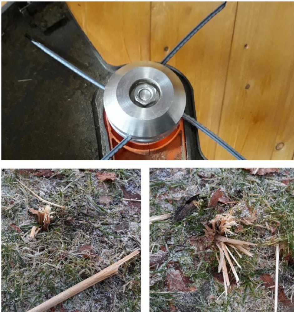
Abbildung 7: Der 4-Faden Mähkopf mit 4mm Fäden (oben), grobes Schnittbild der abgemähten Miscanthus-Stangen (unten).
