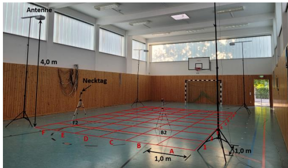
Abbildung 13: Versuchsaufbau des Ortungsversuchs in der Turnhalle des LVG Köllitsch bestehend aus einem 6 m x 9 m großen Raster (rot eingezeichnet), vier Antennen (je eine pro Eckpunkt) und zwei mit Necktag ausgestatteten Stativen
