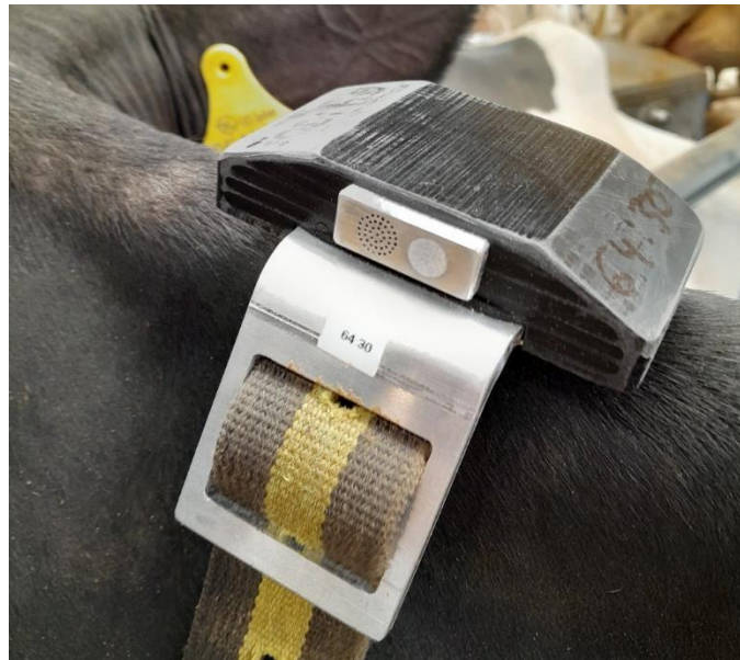
Abbildung 23: Funktionsmuster der 4. Generation mit Luftgütesensor und seitlich angebrachten Luftfilter
