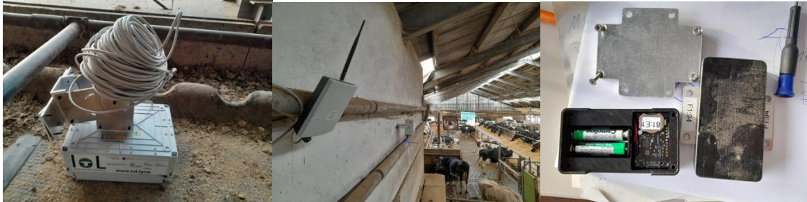
Abbildung 14: links-Antenne A1 vor der Installation, mitte- installierte Bluetooth-Antenne und rechts weiterentwickelte NECKTAG® Multisensoren
