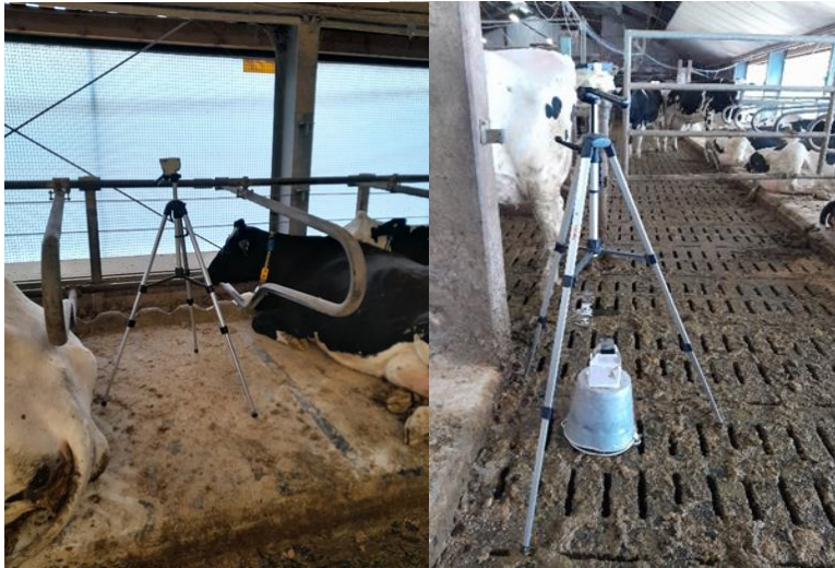
Abbildung 18: Vergleich NECKTAG® Multisensor in 1,45 m und 0,45 m Höhe über Stallboden
