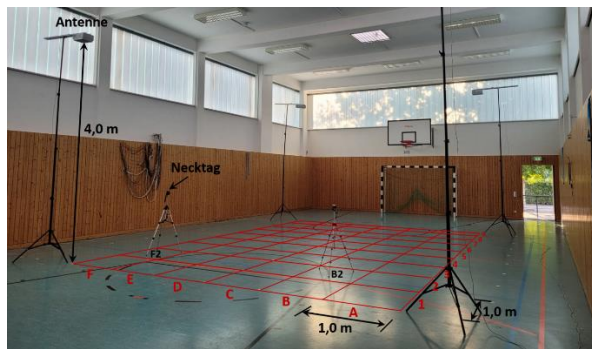
Abbildung 12: Versuchsaufbau zur Überprüfung der Ortungsfunktion der NECKTAG® Multisensoren in der Turnhalle des LVG Köllitsch bestehend aus einem 6 m x 9 m großen Raster (rot eingezeichnet), vier Antennen (je eine pro Eckpunkt)
