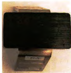
Abbildung 9: Tiertransponder inkl. SE Mikrocontroller-Zentraleinheit mit Funktechnik und Ortungsfunktion & SE eigener Sensorik sowie stalltauglicher Necktag®-Gehäusekonstruktion mit Bügel zur Anbringung am Halsband
