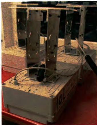
Abbildung 7: Antennenarray mit Gehäuse und externer Aufhängung zur Montage im Stall
