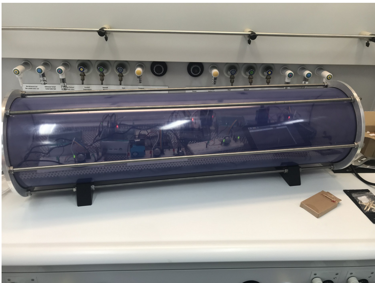
Abbildung 9: CERES-Sensorsignalerzeugungsaufbau. Das Rohr ist gasdicht und erlaubt die definierte Zufuhr unterschiedlicher Gase wie \text{NH}_3 , \text{CO}_2 und die Zufuhr von Staub. Die Sensorik ist mit RaspberryPis verknüpft, die verbunden sind und ein Netzwerk aus Sensoren darstellen. Dieses soll als neuronales Netz betrieben werden.
